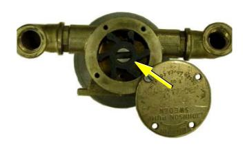
Fig. 7.13.1-5: Impeller
